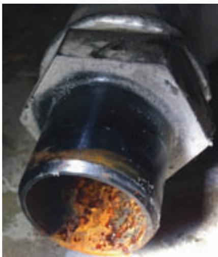
Anschlussmuffe für die Luftversorgung des Bogentrenners mit starkem Korrosionsbefall.
